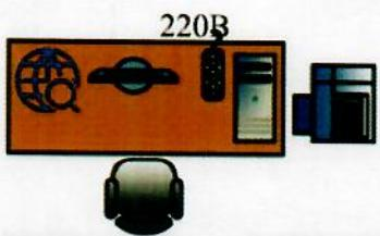
Рабочее место главного эксперта, состоящее из компьютера с монитором, подключенный к интернету на который установлен любой веб-браузер клавиатуры, компьютерной мыши, размещенных на рабочем столе; принтера, компьютерного стула; пилота с розетками 220 В.
