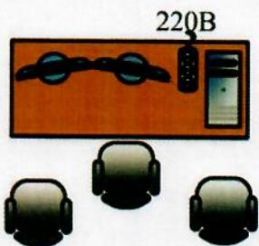
Рабочее место группы оценки, состоящее из системного блока, двух мониторов, клавиатуры, компьютерной мыши, размещенных на рабочем столе; трех стульев; пилота с розетками 220 В.
